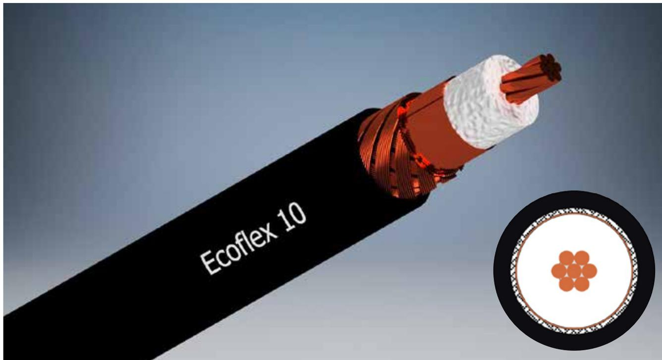
Ecoflex 10 ist ein flexibles und dabei sehr dämpfungsarmes 50 Ohm Koaxialkabel für den Frequenzbereich bis 6 GHz. Modernste Produktionsverfahren und die Verwendung eines verlustarmen PE-LLC-Dielektrikums mit einem Gasanteil von über 70 % ermöglichen geringe Dämpfungswerte, die bei flexiblen Koaxialkabeln dieser Dimension Maßstäbe setzen.
