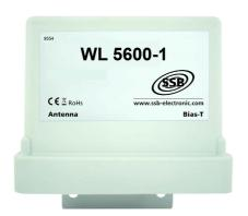
Der WL5600-1 ist ein bidirektionaler Verstärker für den WLAN Frequenzbereich 5,18GHz bis 5,825GHz. mit einer automatischen Er ist Sende-/ Empfangsumschaltung ausgestattet. Die Verstärkung beträgt in Senderichtung min. 25dB. Empfangsrichtung wird eine Verstärkung mindestens 16dB gewährleistet. Die Ausgangsleistung kann bis zu 30dBm (1W) betragen.
